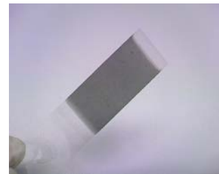
PETフィルムにコーティングした 単層カーボンナノホーンフィルム
