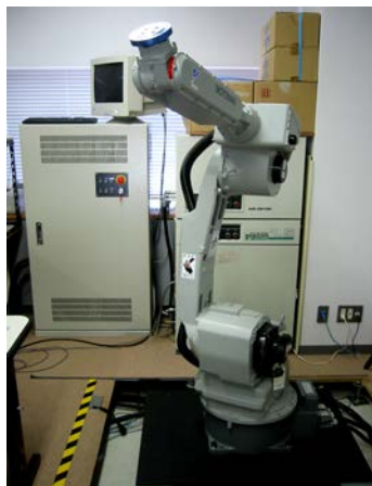
トルク制御用制御盤(研究室で開発)と6軸マニピュレータ
