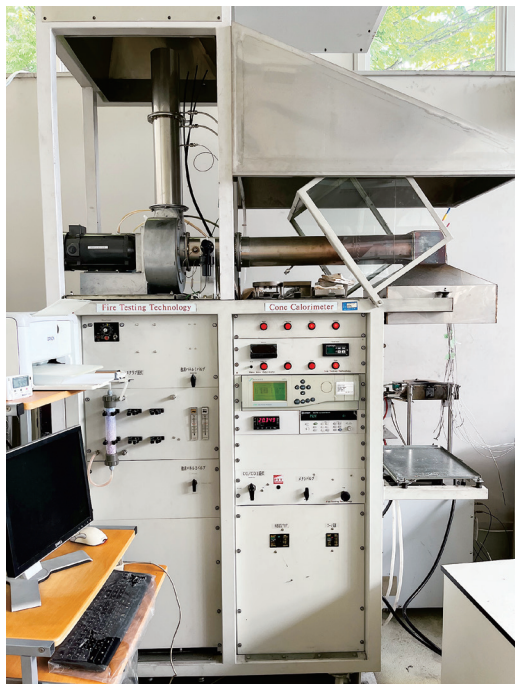
コーンカロリメータ試験装置
