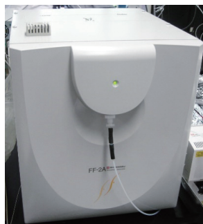
におい識別装置 (島津製作所、FF-2A)
