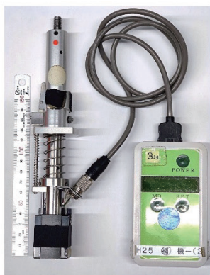
微小球反発試験機eNM3A10(試作機, 昌永工機)
