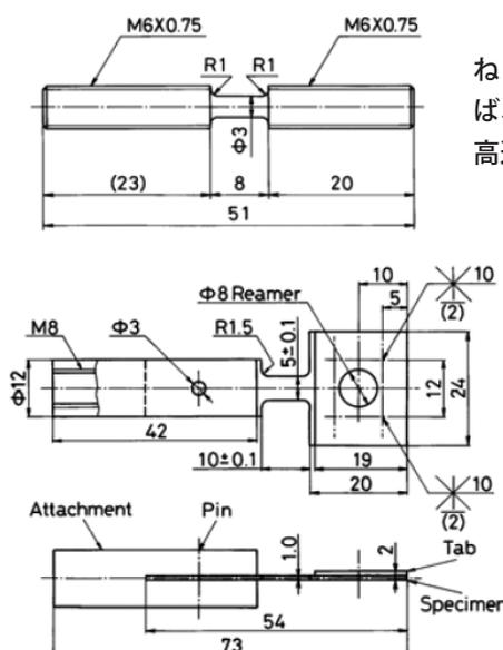
ねじ加工ができる材料であれば、このような丸棒型試験片で高速引張り試験できます。
