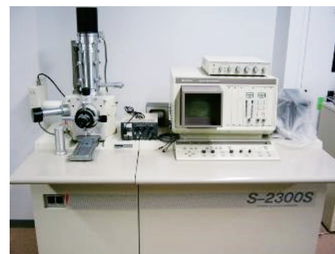
走査型電子顕微鏡 （薄膜評価実験に用いる装置）
