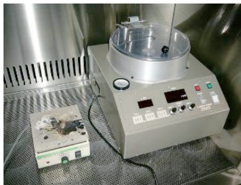
スピニングコーター・イオンコーター（薄膜作製実験に用いる装置）
