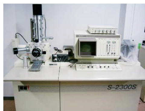
走査型電子顕微鏡 (薄膜評価実験に用いる装置)
