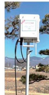
図2 LPWA水位計の設置運用場所（左）とLPWA水位計の外観（右）
