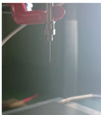
図6 有機薄膜太陽電池の材料を噴霧している様子 (左) ICBA, (右) P3HT
