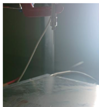
図6 有機薄膜太陽電池の材料を噴霧している様子 (左) ICBA, (右) P3HT
