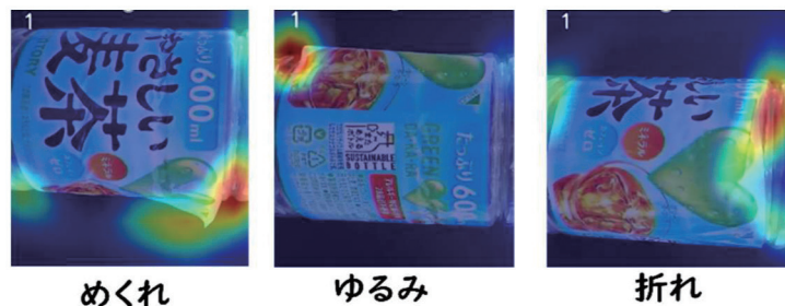
図5 学習済み欠陥検出モデルの挙動例
