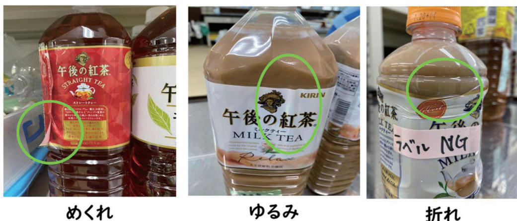
図1 対象とするラベル欠陥の種類
