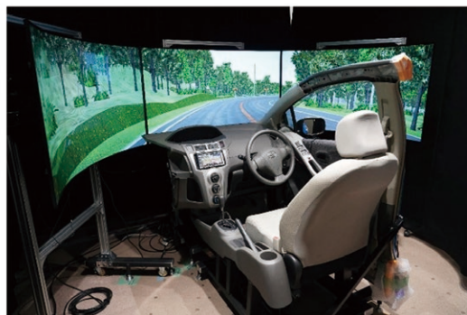
図5 DSモニター装置および評価エリア
