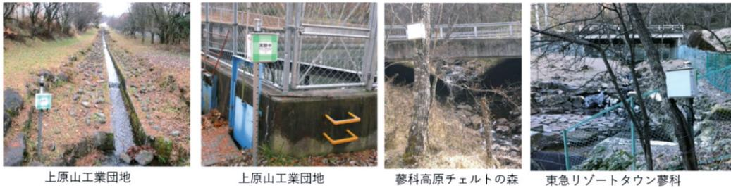
図6 水位センサ設置の様子 (四角い箱に電子回路とバッテリーを収納している)
