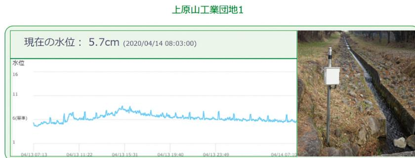
図7 上原山工業団地での水位計測結果 (river.suwarika.com より)
