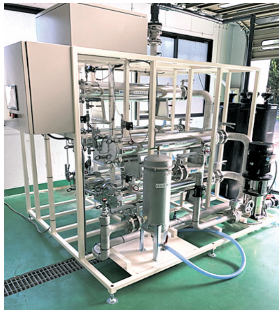
図1 MF膜ろ過（Microfiltration Membrane）方式の装置概要
