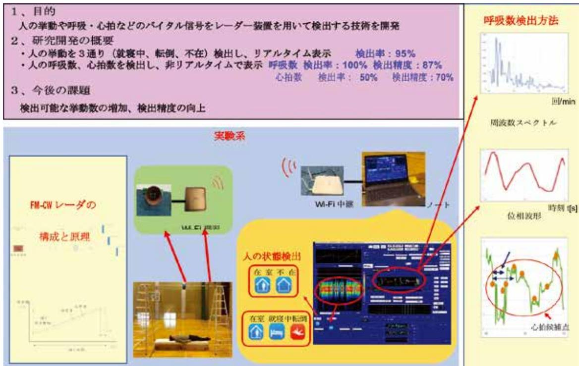
レーダーセンサーからの計測距離の高精度化、呼吸数・心拍数などのバイタルデータの取得と高精度化について取り組んだ。居室空間内の天井にレーダーを設置し、ベッドで寝ている・ベッドから転倒・部屋に不在の基本挙動の検出するための信号処理アルゴリズムを開発し、90%程度の検出精度を実現した。また、呼吸数は80%程度、心拍数は70%程度の検出精度であった。
