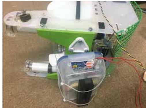
浮力調整装置を搭載した様子
