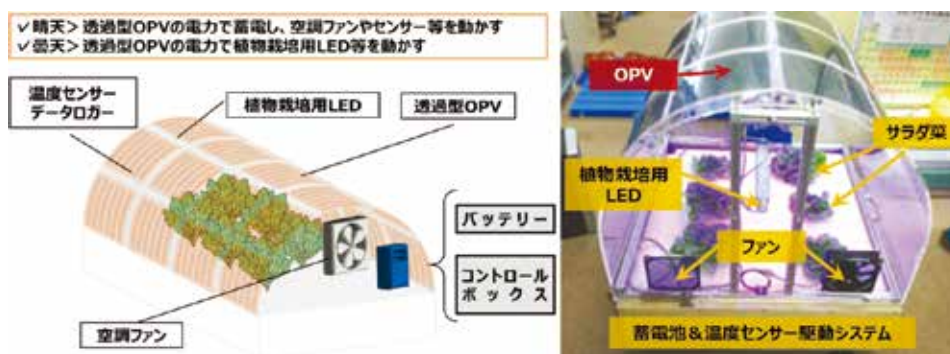
図5 光透過型太陽電池を活用した農業 IoT ソーラーチューニング
