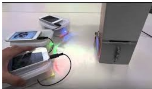
可視光通信装置を電子工作することで、 無線通信の仕組みについても理解
