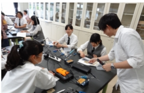
音楽をLEDの光にのせて通信する 可視光通信装置を電子工作
