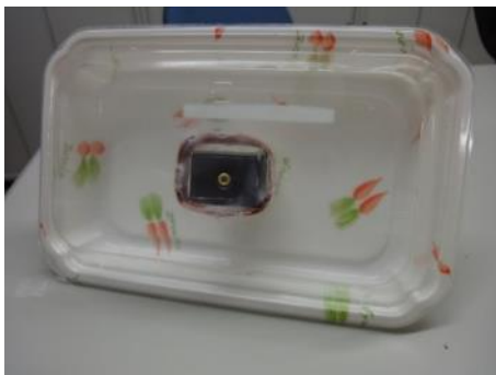
100円ショップの材料を用いて、 手作りスピーカーを製作
